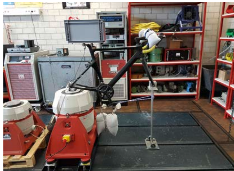
Abbildung 1: Versuchsaufbau Shaker: Rennradrahmen mit Schwabbelmassen und Messtechnik
