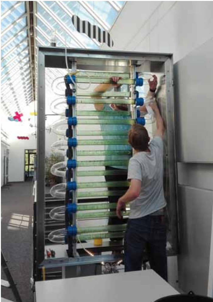
Abb. 2: Als Vordemonstrator für die Fassadenintegration entwickelte Plattformtechnologie des emersen Photobioreaktors (ePBR), Standort Hochschule Augsburg.
