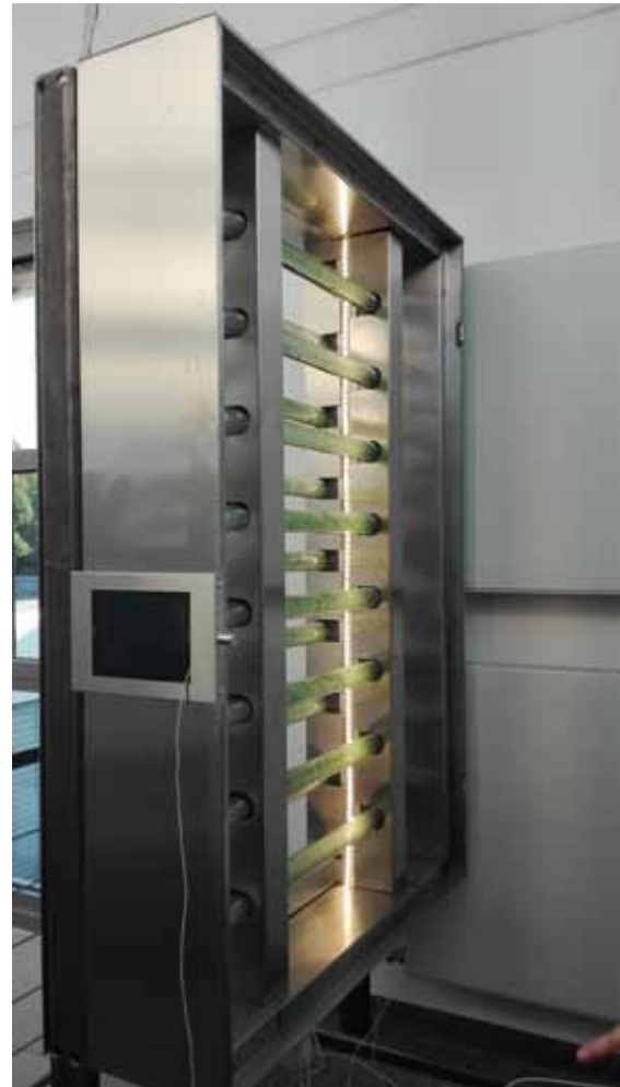
Abb. 2: Als Vordemonstrator für die Fassadenintegration entwickelte Plattformtechnologie des emersen Photobioreaktors (ePBR), Standort Hochschule Augsburg.
